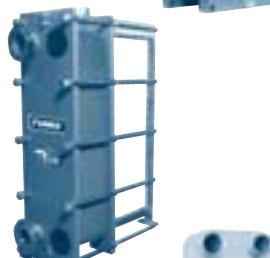
Теплообменник повышенной надежности с двойными стенками. Теплообменные пластины состоят из двух рефленых пластин, образующих узкий канал утечки среды. Пластины уплотнены стандартным методом.
