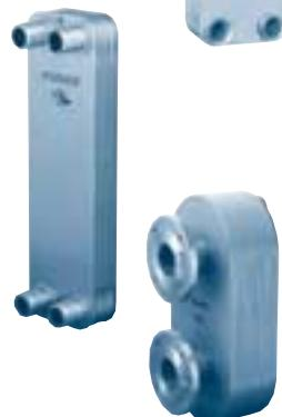
Пластинчатый теплообменник повышенной надежности в паяном исполнении. Отдельные проточные каналы образованы двумя паяными пластинами с встроенными турбулентными деталями. Для создания полости безопасности специальная промежуточная пластина встраивается между каждой парой теплообменных пластин. Благодаря этому полностью исключается смешение сред в теплообменнике.
