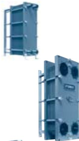
Пластинчатый теплообменник состоит из пакета профилированных теплопередающих пластин, оснащенных уплотнениями, разделяющими проточные каналы сред. К данной серии относится полуварной теплообменник типа FPG, в котором пластины свариваются с одной стороны, образуя так называемые "кассеты". Другая сторона проточных каналов уплотняется стандартным методом.
